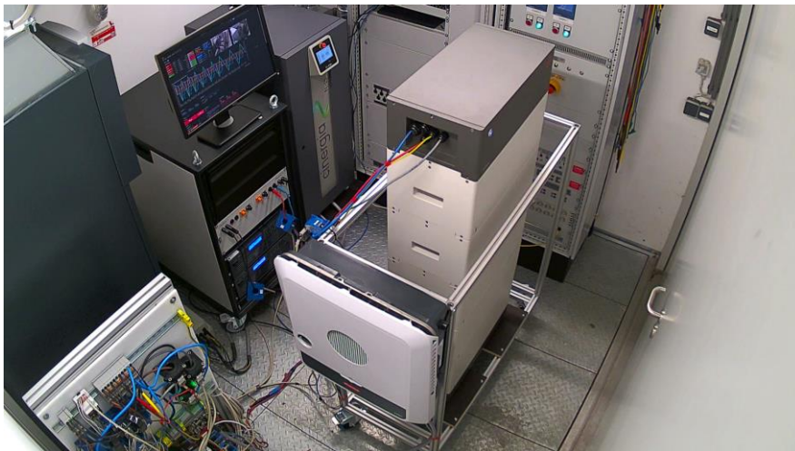
Bild 18 Prüfstand des Austrian Institute of Technology (AIT) in Wien, auf dem der Hybridwechselrichter FRONIUS Symo GEN24 12.0 Plus SC in Kombination mit der BYD Battery-Box Premium HVS 12.8 vermessen wurde. Insgesamt 8 Speichersysteme, die in dieser Studie verglichen werden, hat das AIT getestet (Bild: AIT).
